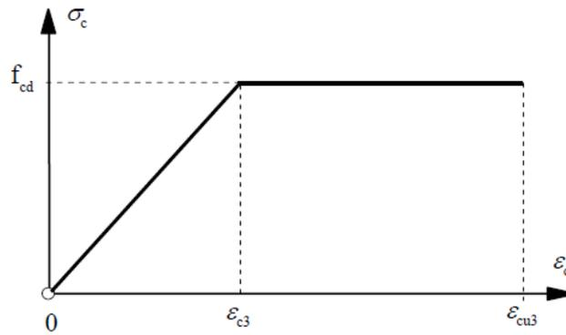
Figure 8 : Loi de comportement béton ELU de type élasto-plastique
