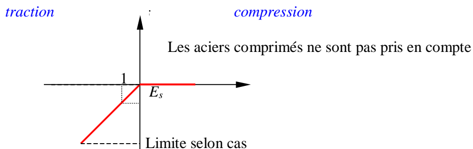
Figure 10 – Diagramme contrainte-déformation de l'acier passif à l'ELS
